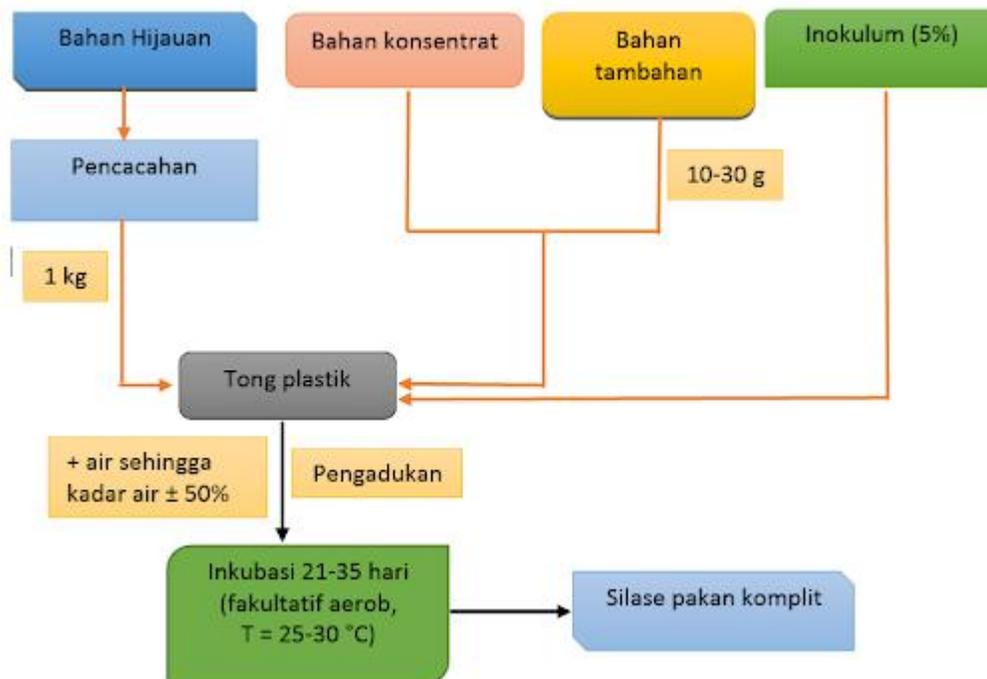
Gambar 6. Tahapan Proses Pembuatan silase
