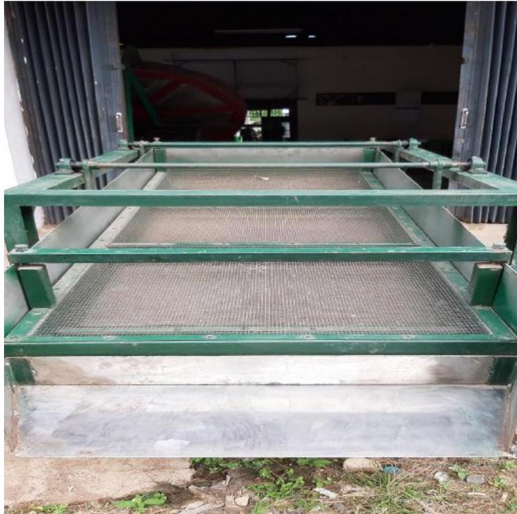
Gambar 15. Saringan untuk ukuran granul yang diinginkan
