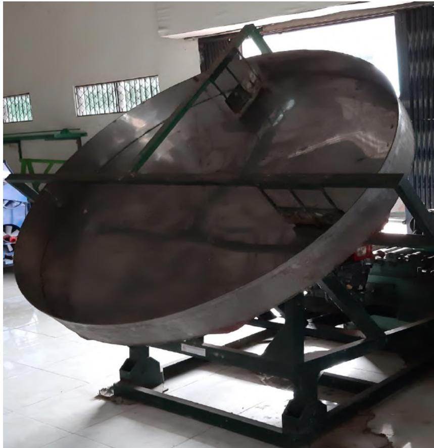
Gambar 14. Mesin Granulator untuk pembuatan pakan bentuk granul
