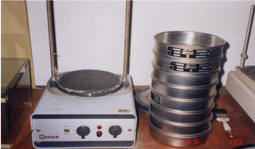
Gambar 25. Alat Pengukur Kehalusan Bahan Pakan tyler sieve rettsch 5657 haan; type vibro, W. Germany.
