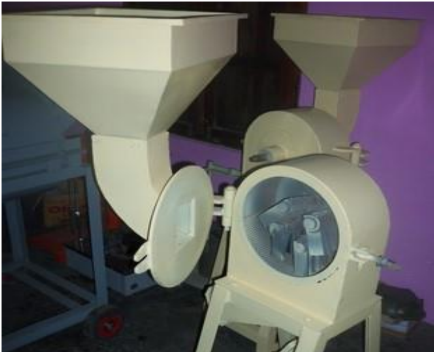
Gambar 6. Mesin Penepung dengan Penampakan Palu Pemukul yang Bisa Bergerak
