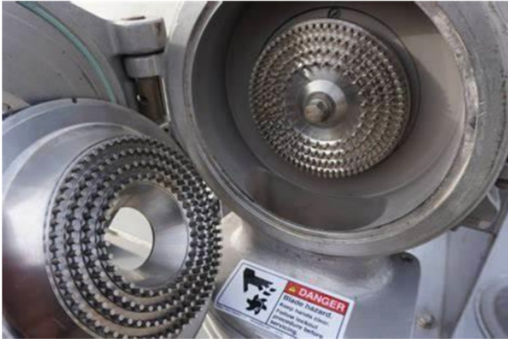
Gambar 10. Pin Mill yang Digunakan dalam Pesin Penepung
