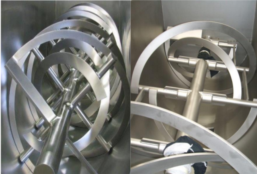
Gambar 15. Alat Pengaduk pada Bagian dalam Mesin Mixer Type Horizontal
