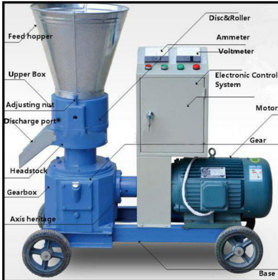
Gambar 23. Mesin Pencetak Pellet Berikut Bagiannya
