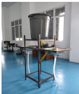
Gambar 4. Wastafel Portabel Sistem Pedal yang di buat oleh Mahasiswa Teknik Mesin UMKT
