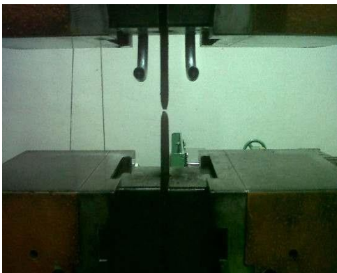
Gambar 5. Pengujian Kuat Tarik Baja Tulangan
