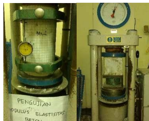
Gambar 6. Benda Uji, Dial Gauge dan Compression Test
