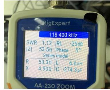
Gambar 10. Impedansi dan *Return Loss* Antena *Monopole*
