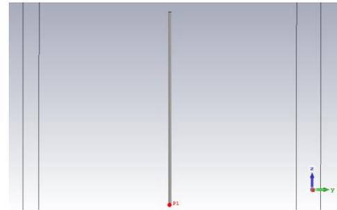
Gambar 1. Desain Antena *Monopole*
