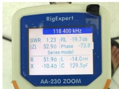
Gambar 12. Impedansi dan *Return Loss* Antena *Yagi*
