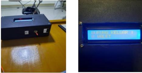
Gambar 4.4.2 Pengujian Sakelar SPDT dalam posisi burung keluar (*Single Pole Double Throw Switch*)
