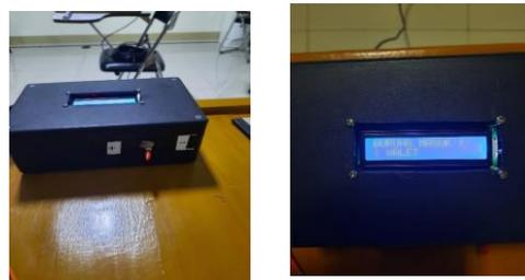
Gambar 4.2.2 Pengujian Sakelar SPDT dalam posisi burung masuk (*Single Pole Double Throw Switch*)
