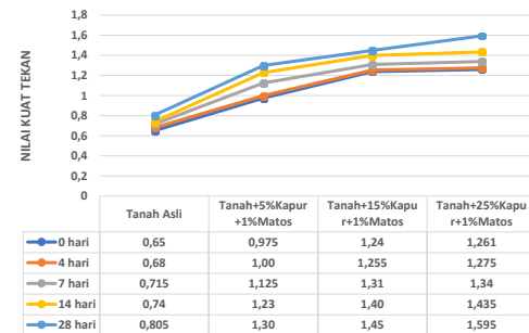
Gambar 4.6 Hasil pengujian kuat tekan bebas tanpa rendaman ( Unsoaked ) pada titik 2 (Sumber: Hasil Uji Laboratorium Politeknik Negeri Banjarmasin, 2022)
