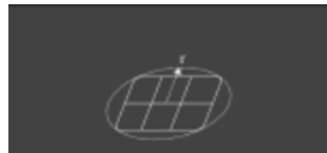
Gambar 3 Memparalel Elektroda / Sistem Mesh
