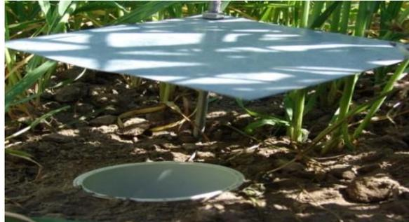
**Gambar 3.** Penempatan Pitfall Trap perangkat serangga permukaan tanah (Koleksi Pribadi)
