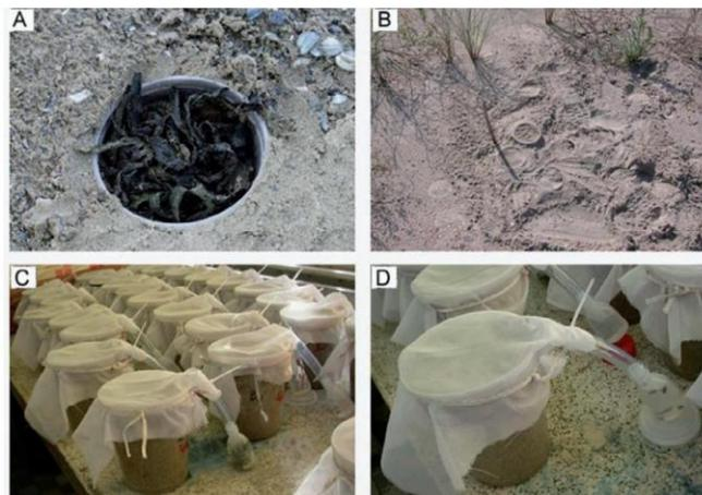
**Gambar 5.** Mengumpulkan serangga di pantai dengan perangkap kemunculan berumpan. A. Rumput laut yang baru dipotong diletakkan di atas vial yang berisi pasir dan B. digali ke pantai selama dua minggu; C. Selanjutnya vial-vial dipindahkan ke laboratorium dan D. penutup dan toples penampung diisi dengan alkohol 70 atau 90% terpasang. Serangga yang muncul dikumpulkan setiap minggu selama periode dua bulan. (Foto oleh Wouter Dekoninck & Patrick Grootaert).
