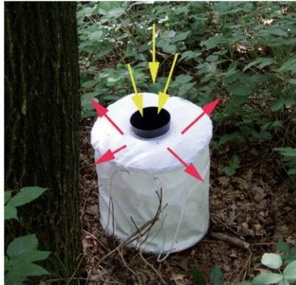
**Gambar 10.** Perangkat hisap BG-Sentinel awalnya dirancang untuk mengumpulkan nyamuk. Tanda panah menunjukkan aliran konveksi dengan panah kuning sesuai dengan udara yang dihisap, dan panah merah menunjukkan aliran udara yang membawa bau umpan keluar dari perangkat. Karena warnanya yang putih, banyak penyerbuk dikumpulkan (Foto oleh Wouter Dekoninck).
