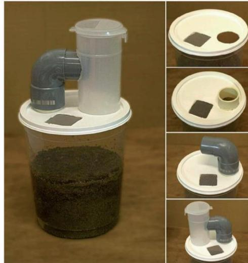
**Gambar 8.** Guci pengumpul perangkat kemunculan yang terbuat dari tabung pipa ledeng. Tidak diperlukan lem untuk memperbaiki bagian-bagian yang terpisah kecuali jala. (Foto oleh Filip De Block).
