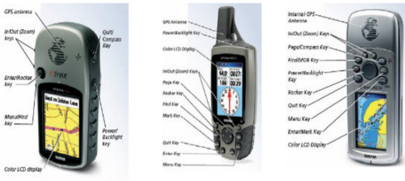
Gambar 4.2. Contoh Alat Navigasi Sederhana yang Digunakan Nelayan
