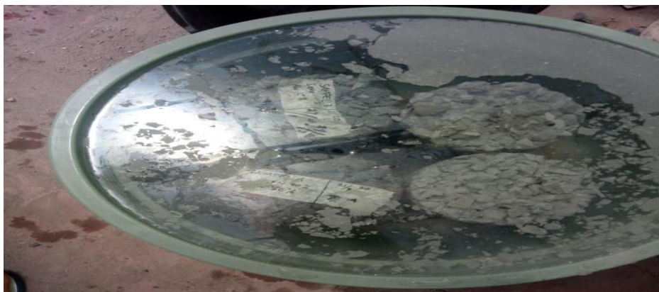
Gambar 6. Perawatan dengan Air PDAM
