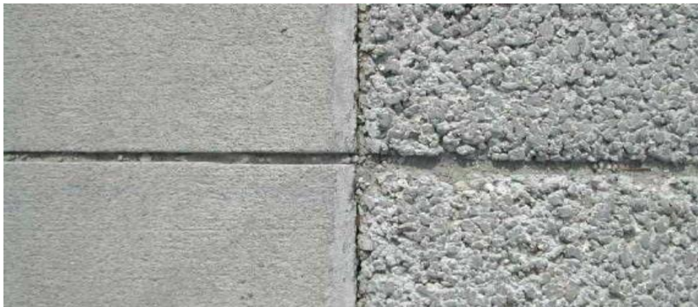
Gambar 1. Perbedaan Tekstur Permukaan Beton Berpori Dengan Beton Normal
