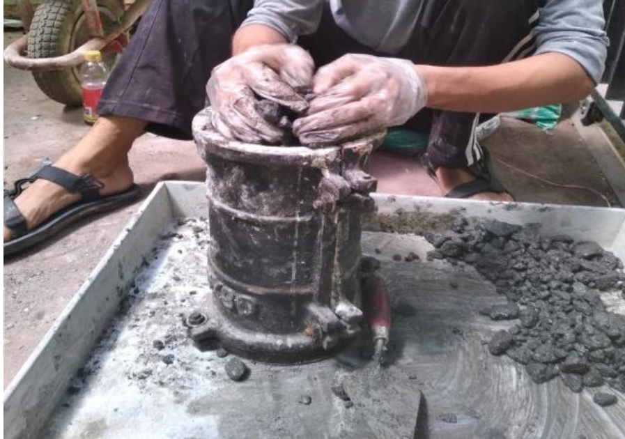
Gambar 5. Pembuatan Benda Uji Beton Porous
