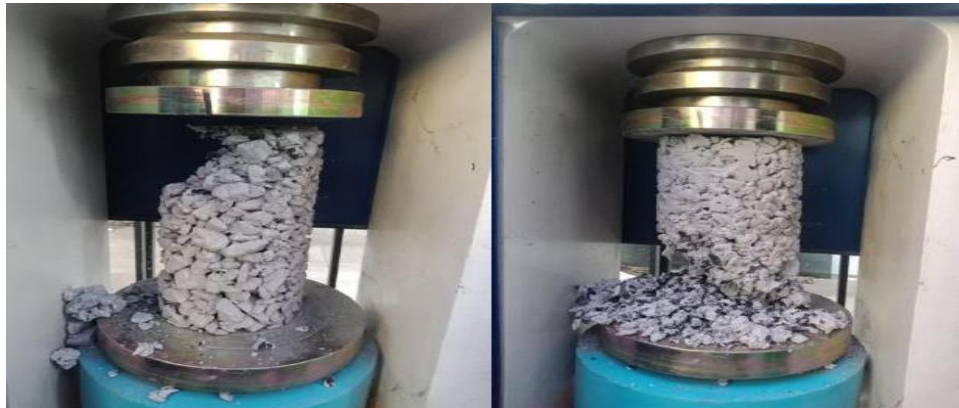
Gambar 7. Pengujian Kuat Tekan Beton Porous
