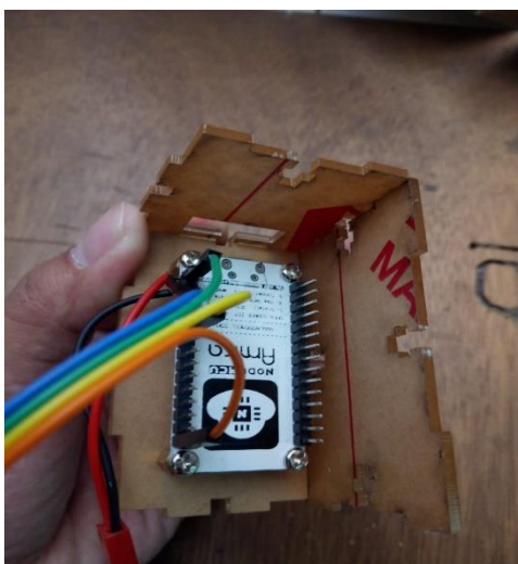
Gambar 9. Perangkaian NodeMCU ESP8266 Dengan Sensor MQ-7
