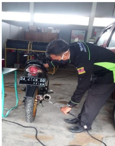
Gambar 4. Proses Pemasangan Probe Gas Analyzer
