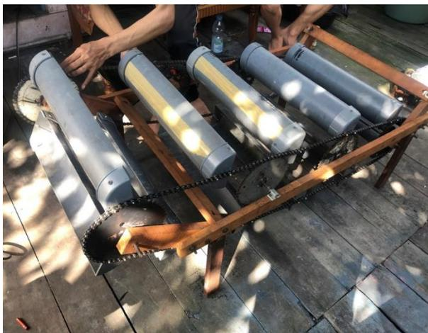
Turbin Air yang dibangun mempunyai 11 buah sudu yang dibuat dari pipa dan tutup pipa dengan diameter 4 inch
