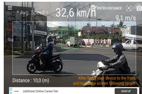
Gambar 4.3. Kecepatan Kendaraan Sepeda Motor Menggunakan Aplikasi Speedgun
