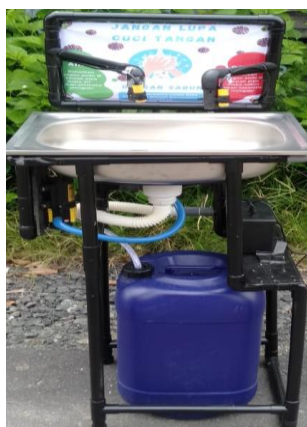
Gambar 2. Pengujian alat pencuci tangan otomatis menggunakan arduino
