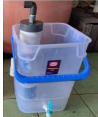
Gambar 3.4. filter ke 3 dan tempat penampungan akhir
