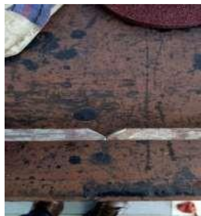
Gambar 2. Kampuh V (sumber: dokumentasi pribadi)
