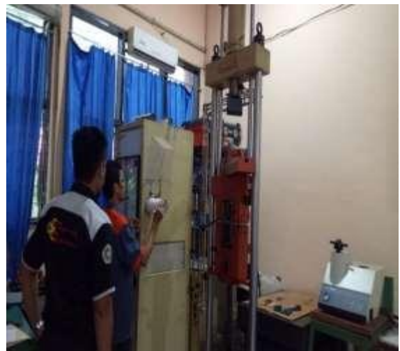
Gambar 5. Proses pengujian tarik (dokumentasi pribadi)
