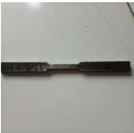
Gambar 4. Spesimen JIS Z 2201 1981 (sumber: dokumentasi pribadi)
