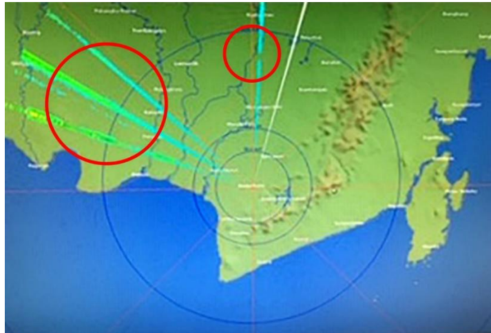
Gambar 4.1 Tampilan pada monitor radar pada posisi Off Radiate
