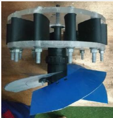
Gambar 6. Turbin Hasil Perancangan
