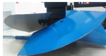
Gambar 4. Sudu Jalan Hasil Perancangan
