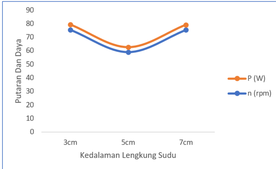
Gambar 5 Hubungan kedalaman lengkung sudu terhadap putaran dan daya pada kecepatan angin 3,9 m/s
