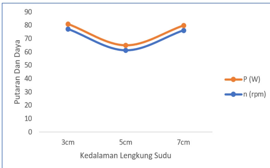
Gambar 6 Hubungan kedalaman lengkung sudu terhadap putaran dan daya pada kecepatan angin 4,5 m/s
