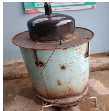
Gambar 3.2 Reaktor Asap Cair ( Sumber : Data Pribadi )
