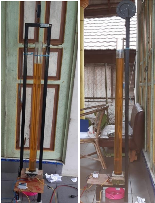
Gambar 21 Rancang bangun alat ukur viskositas fluida secara keseluruhan Sumber : Dokumentasi pribadi
